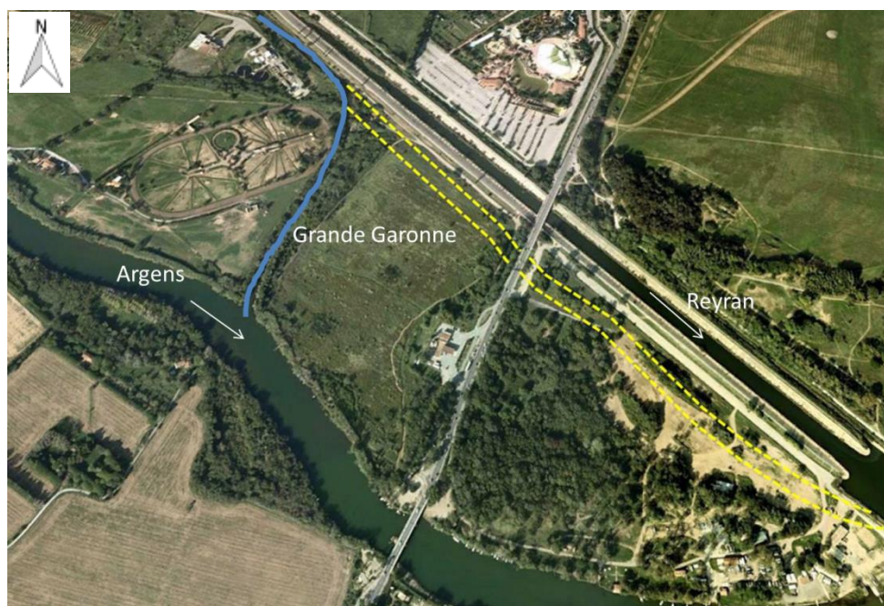
Figure 15: emprise indicative du chenal prolongeant l'exutoire de la Grande Garonne (source : SCE, 2014)
